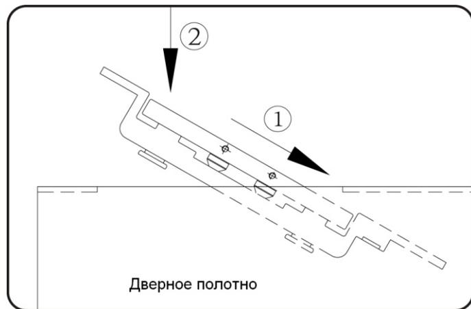
*Использование крепежных пластин*
